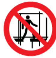
P025 Non utilizzare un'impalcatura incompleta
