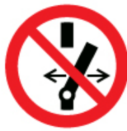
P031 Non modificare la posizione dell'interruttore
